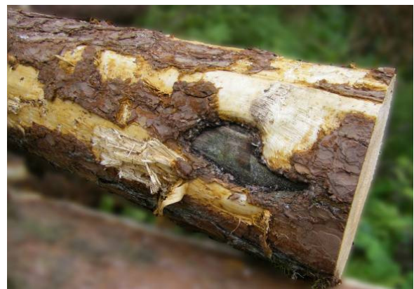
Joonis 13. Pindmine mõlu saepalgi tüükaotsal, mis ei ulatu töötlemissilindrisse.
