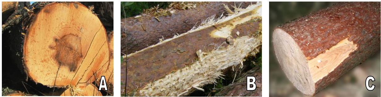
Joonis 21. Mehhaaniliste vigastuste näiteid. A- järkamislõhed noti otspinnal; B- harvesteri rullikukahjustus; C- pindmine järkamisrebend männipalgi tüükaotsal, mis ei ulatu töötlemisilindrisse.
