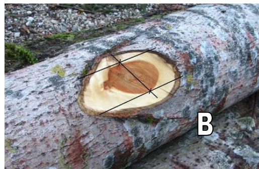
Joonis 1. Oksa diameetri mõõtmine. A- okaspuupalk; B- lehtpuupalk.
