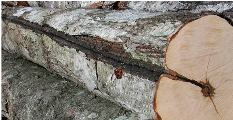
Joonis 12. Külmalõhe kase noti külg- ja otspinnal.
