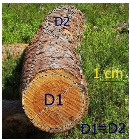
Joonis 7. Töötlemisilindri projektsioon männipalgil. D1 palgi ladvaotsal ja D2 tüükaotsal.
